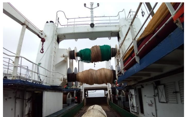
Figura 7- Rede de fundo (verde); Rede pelágica (bege) (Embarcação: Noruega). Foto: Rita Matos
